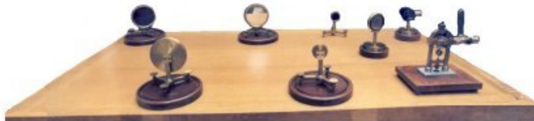
Dispositif expérimental, exposé au musée, de détermination de la vitesse par la méthode du miroir tournant
