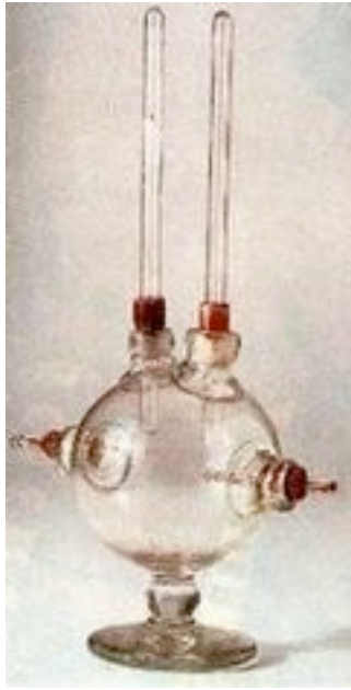
Cuve à électrolyse de Faraday (Daniell et Faraday)
