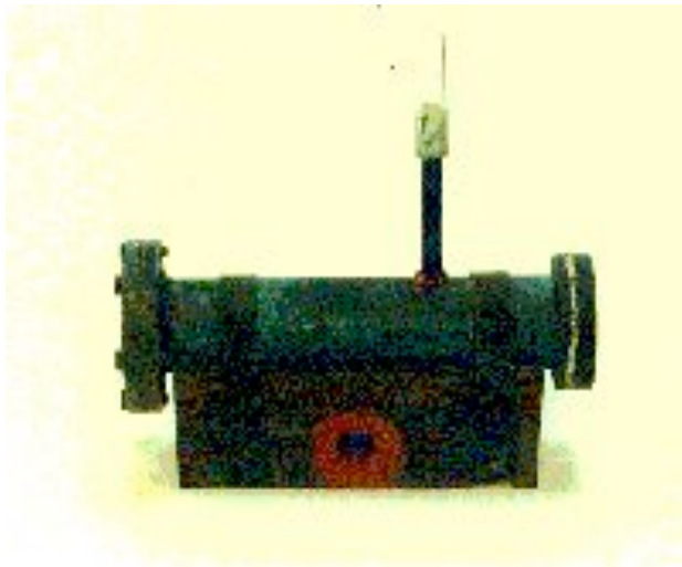
La chambre à neutrons de Chadwick
